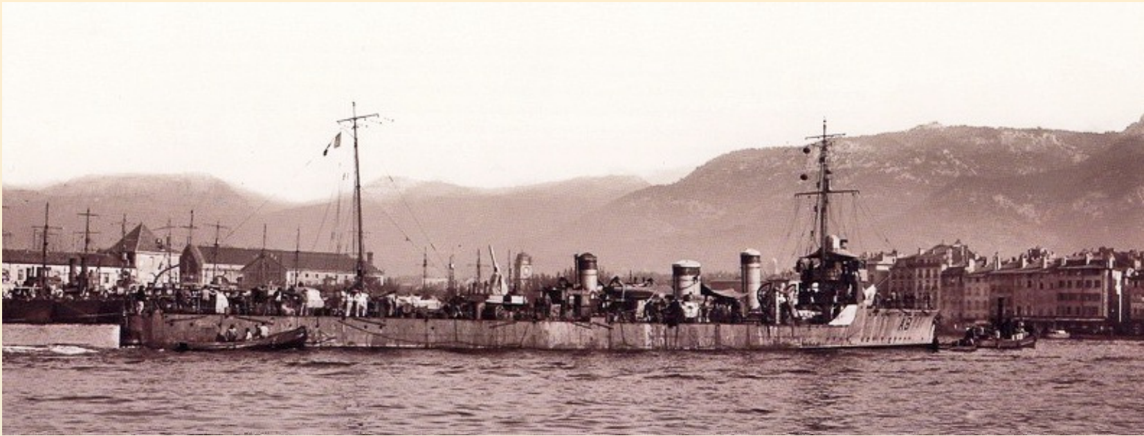
L'Algérien , torpilleur fabriqué au Japon (1917-1936). 4 chaudières à chauffe mixte. 102 t de charbon, 118 t de mazout.
